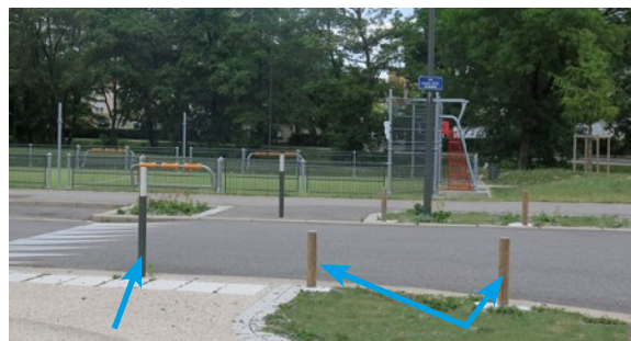
Potelet dans le cheminement piéton, respectant l'abaque de détection et la demande de contraste
