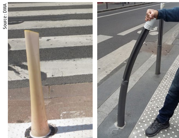
Photo de gauche : potelets lumineux reprenant le signal du feu. NB : Ce mobilier est expérimental (la réglementation actuelle ne l'autorisant pas); ce principe reste à évaluer.
