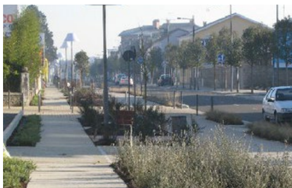
Dans cet exemple, il n'y a pas de limite physique (bordure, lice, muret, etc.) entre le cheminement piéton, les végétaux et la piste cyclable, mais cela ne nuit pas à la lisibilité des espaces
