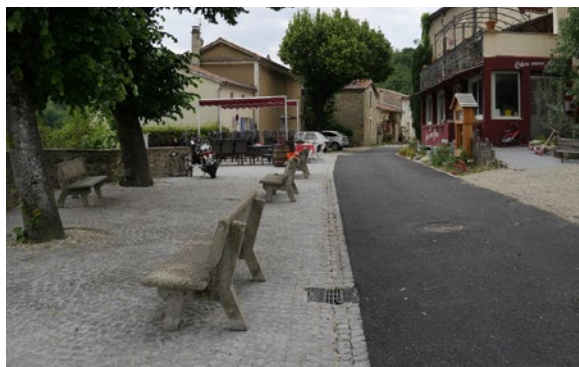
Mobilier d'assise mis en place en bordure de chaussée dans cette rue à vitesse modérée pour canaliser les véhicules
