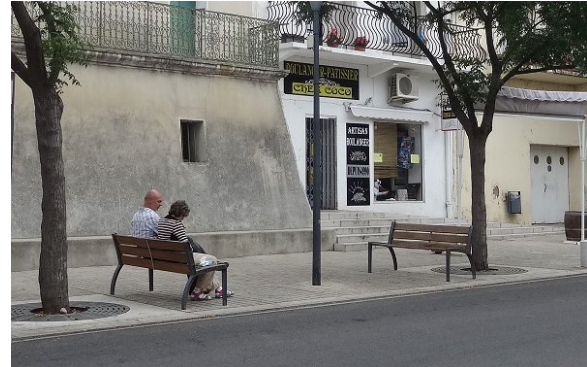
Lorsque le trottoir est suffisamment large, des plantations, des bancs ou des haies peuvent assurer une protection efficace du trottoir contre le stationnement
