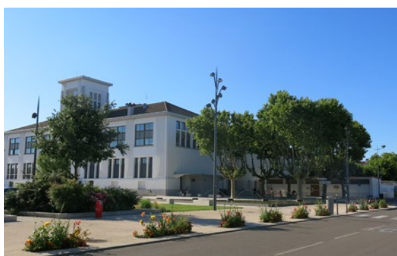
Ici, la bande végétale est discontinue. Ajouté à une bordure basse et une vitesse réduite (zone 30), cet aménagement permet aux piétons de traverser la chaussée facilement
