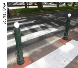
Exemples de potelets a priori conformes aux exigences de contraste visuel (soit entre le potelet et son environnement, soit entre les deux parties du potelet) et de dimensions
