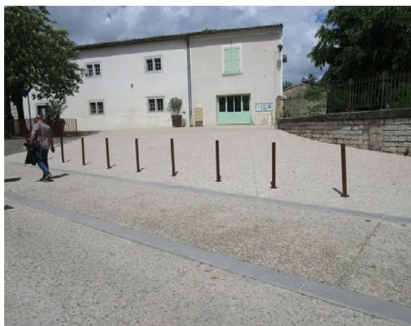
Dans cet environnement homogène, les potelets ont été choisis pour être contrastés par rapport au contexte. Il n'a pas été jugé nécessaire de rajouter une bande contrastée en partie haute
